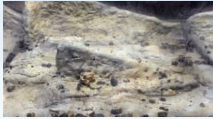
岩の質感を表したモルタル製の自作擬岩
